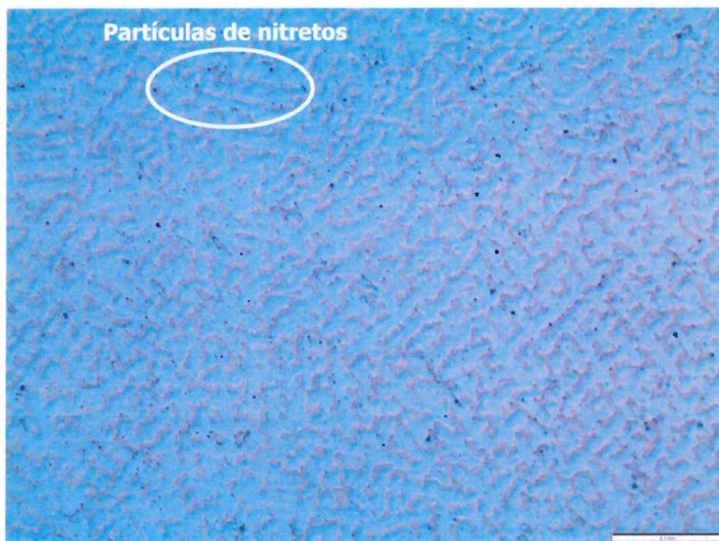
Figura 5.13 – Microestrutura do metal de solda, onde nota-se a estrutura gama e os pontos escuros sendo possíveis nitretos dispersos na matriz. Ataque com Kalling's. Aumento: 200X.
