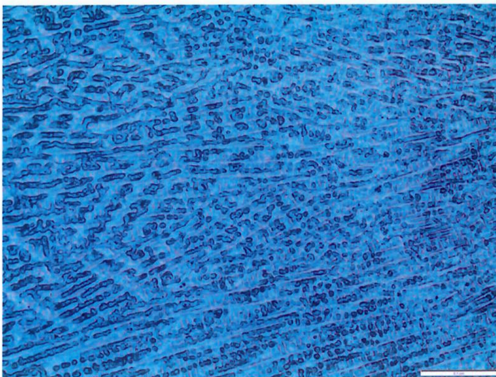
Figura 5.14 – Microestrutura do metal de solda após ensaio ASTM A262/14 Prática A. Ataque com ácido oxálico a uma concentração de 10%. Aumento: 200X.
